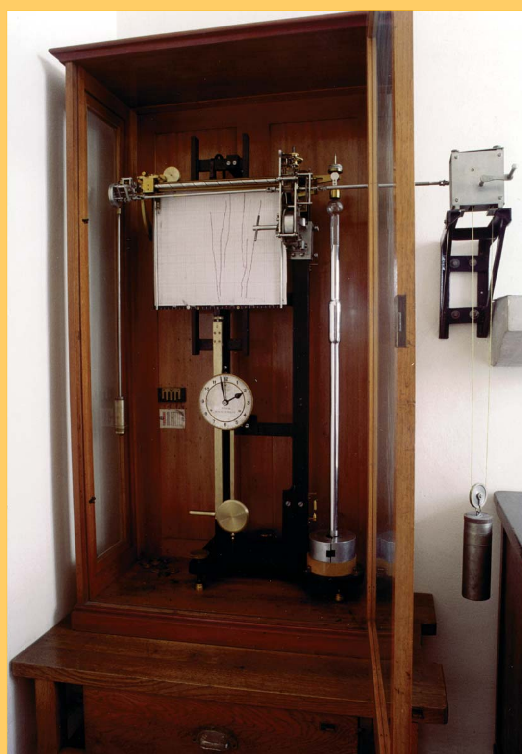
Historický barograf (tlakoměr se záznamem) na stanici Praha-Klementinum.
