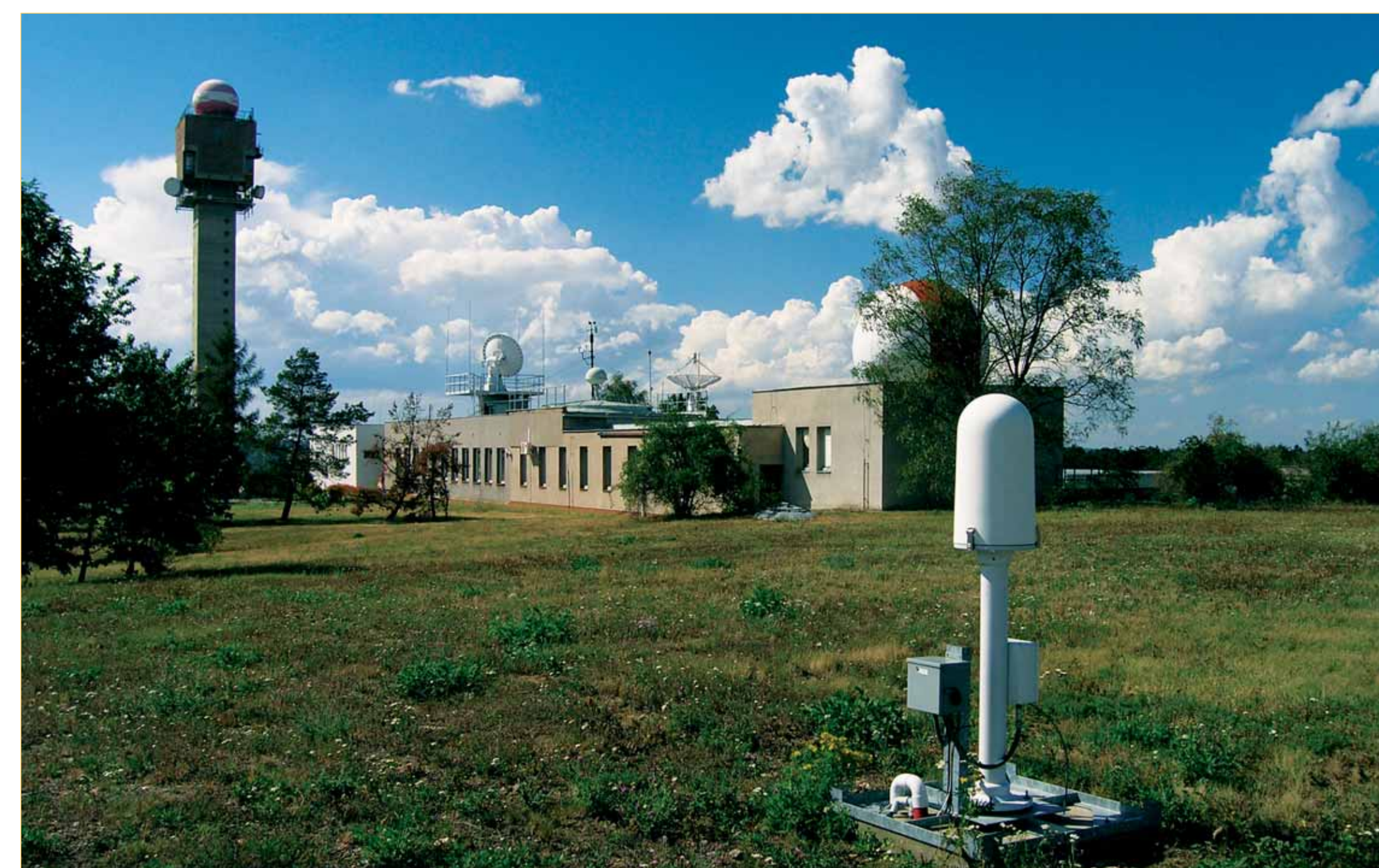
Detektor bleskových výbojů na observatoři Praha-Libuš.
