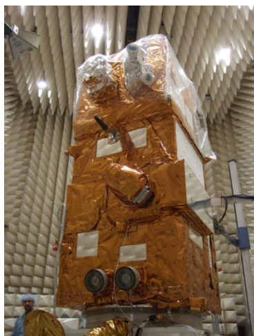
Vlevo: Testování družice Sentinel 2A, vpravo: kresba. Zdroj: ESA.
